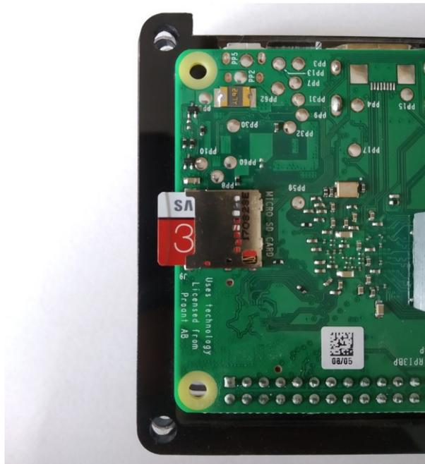
*Figura 12. Scheda di memoria SD inserita nel lettore di schede del Raspberry Pi 3 Model B+*
