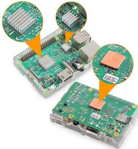
*Figura 10. Applicazione dissipatori sul Raspberry Pi 3 Model B+*
