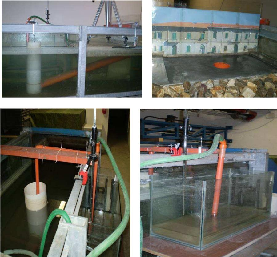
Foto 5.1 - Componenti dell'apparato per la misura dei volumi di overtopping.
