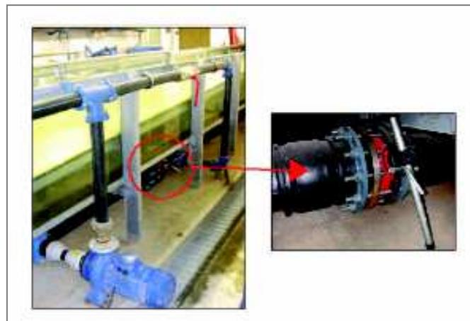
Foto 3.5 - Particolari del sistema di ricircolo: pompa di aspirazione e valvola di chiusura.
