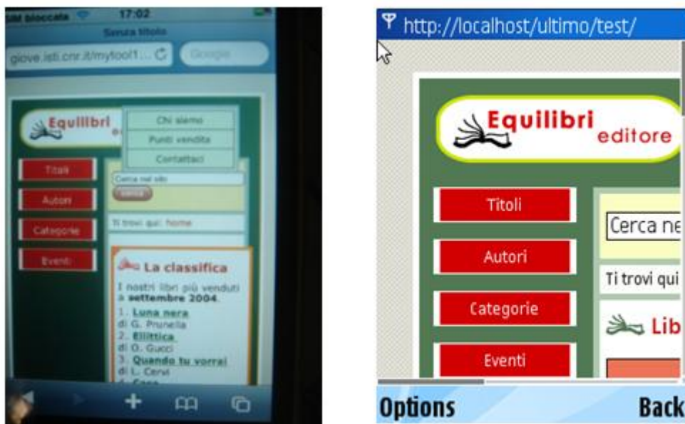
Figura 54 I browser mobili non visualizzano il secondo frame fisso nella parte inferiore dello schermo
