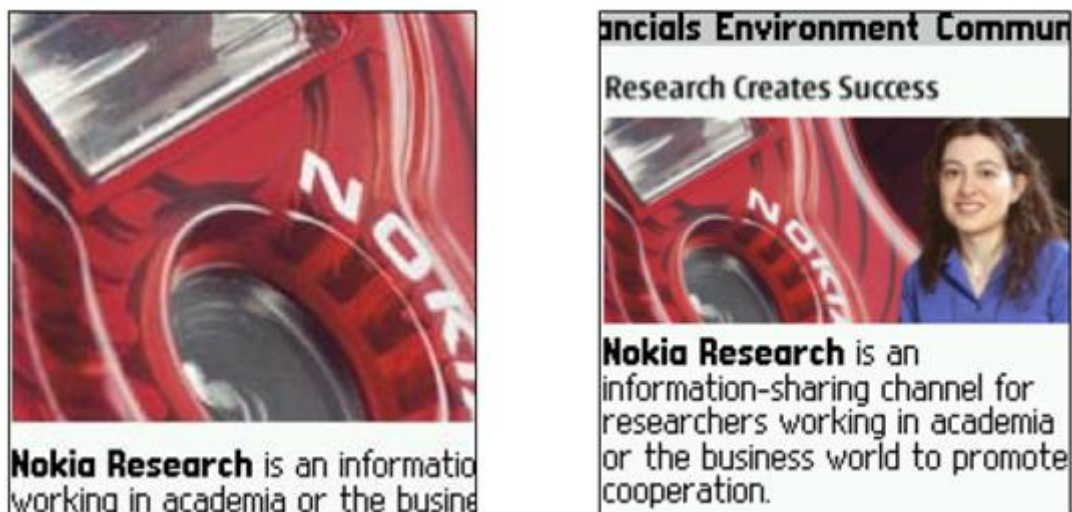
Figura 9 Visualizzazione in original layout di una pagina su un microbrowser (a sinistra), visualizzazione della visualizzazione della pagina dopo che è stato applicato il layout scaling method (a destra)
