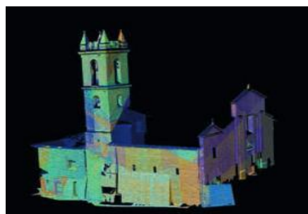
Rizzo: Allineamento delle scansioni laser e dei modelli derivanti dal rilievo fotogrammetrico in Polyworks Innovmetric 124
